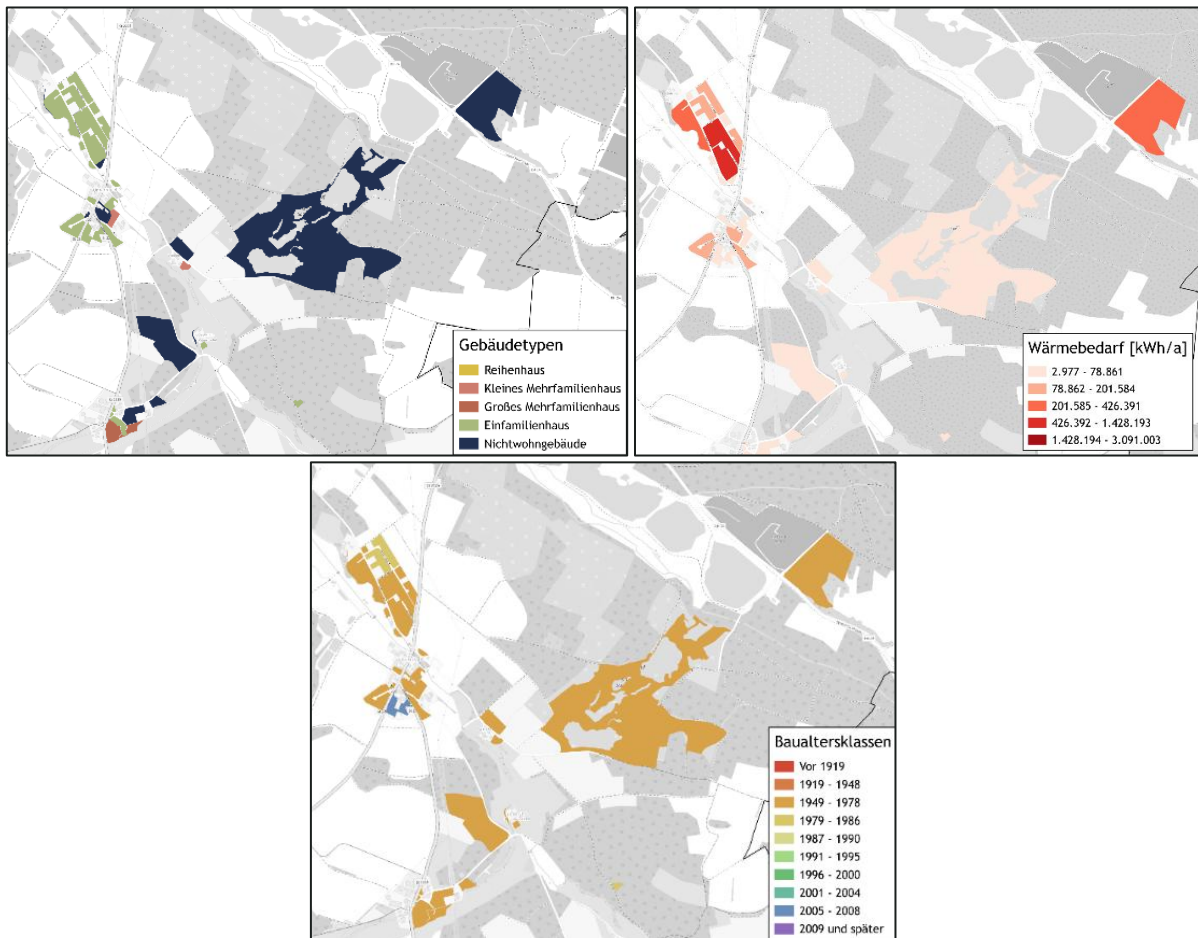
Abbildung 38: Gebäudetypen, Baualterklassen und Wärmebedarf im Fokusgebiete Ober- und Unterrödel, eigene Darstellung
